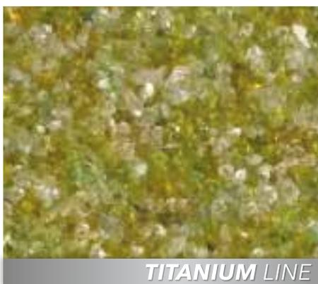
La qualità di filtrazione di **BIOVITRUM Ti** è perdurante nel tempo, essendo il ricoprimento in titanio fissato permanentemente sulla superficie del media filtrante e inattaccabile dagli agenti chimici presenti nell'acqua. Lo speciale ricoprimento assicura una minor frequenza dei controllavaggi e una conseguente ridotta manutenzione del filtro.
