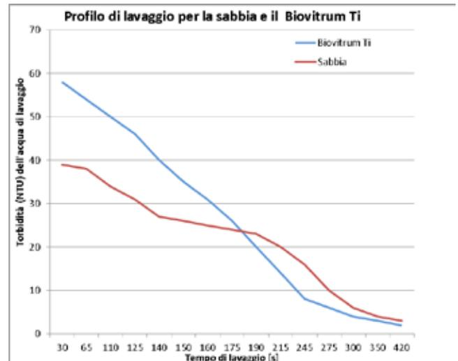
La curva mostra il confronto dell'acqua di controlavaggio di un filtro a sabbia e a Biovitrum Ti. Il filtro con Biovitrum Ti espelle fino al 35% in più di impurità.
